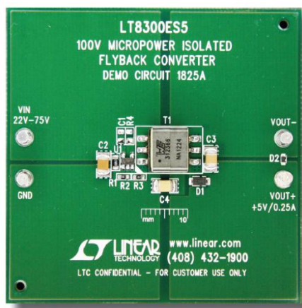
图 2: 在标准演示电路板 DC1825A 中，LT8300 隔离反激式转换器解决方案的尺寸小于 1 英寸 x 1/2 英寸
